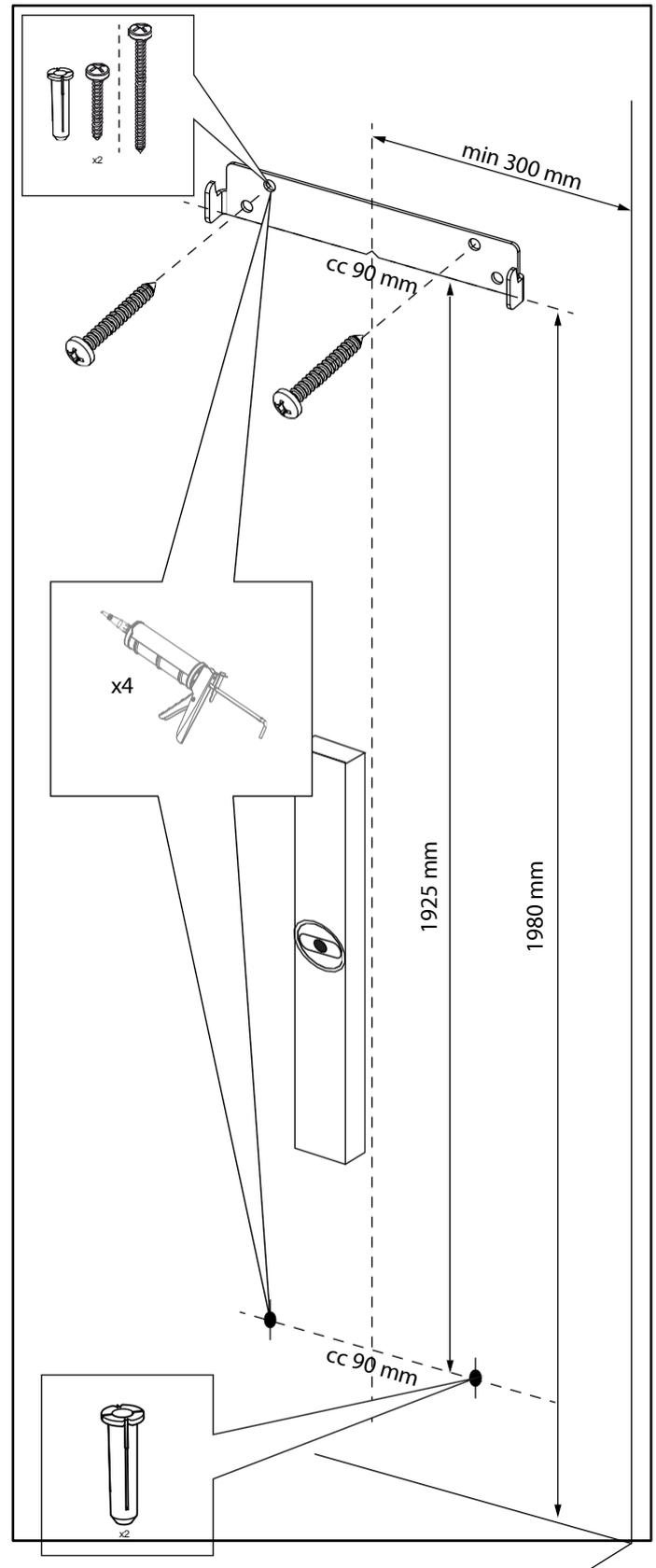
Fig. 2 Misurare, praticare (5,5 mm) i 4 fori, tappare, sigillare con silicone e avvitare la staffa in posizione con le viti in acciaio inox in dotazione (se adatte al materiale della parete, carico 45 kg) nei fori superiori.
