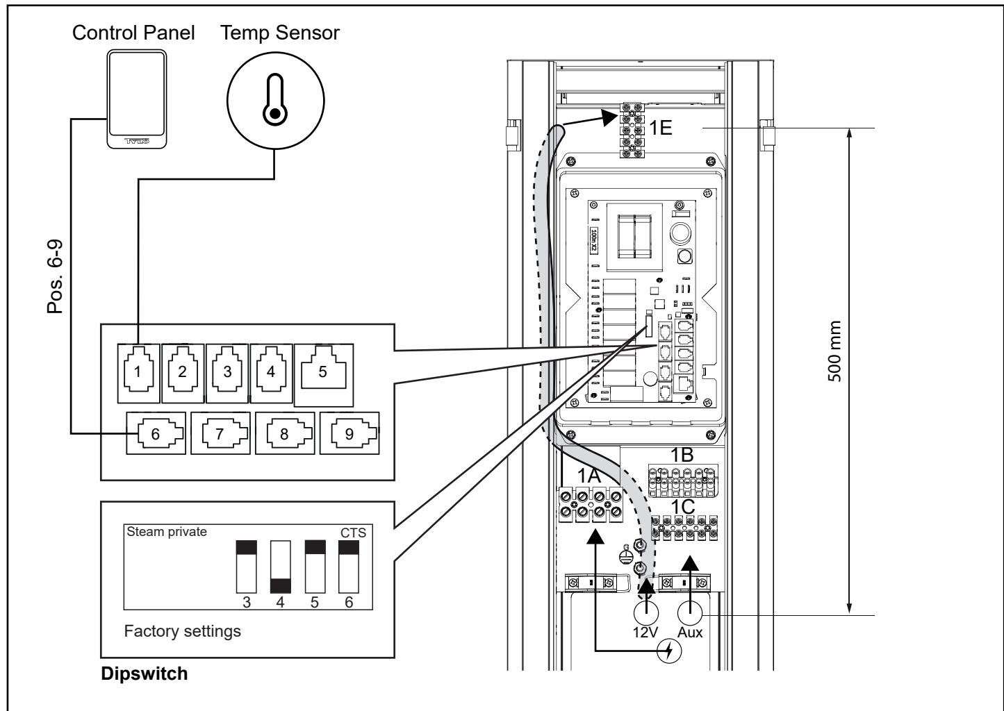
Afb. 5 Schematisch diagram van installatie, Stella stoomgenerator
