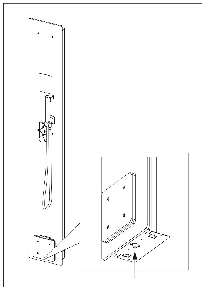
Kuva 13 Lämpötilakatkaisun nollaaminen
