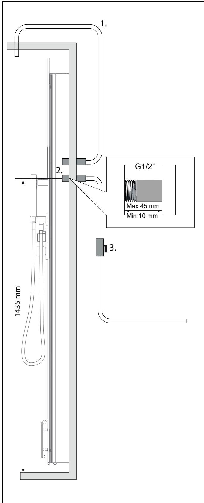
Рис. 3 Подключение воды
