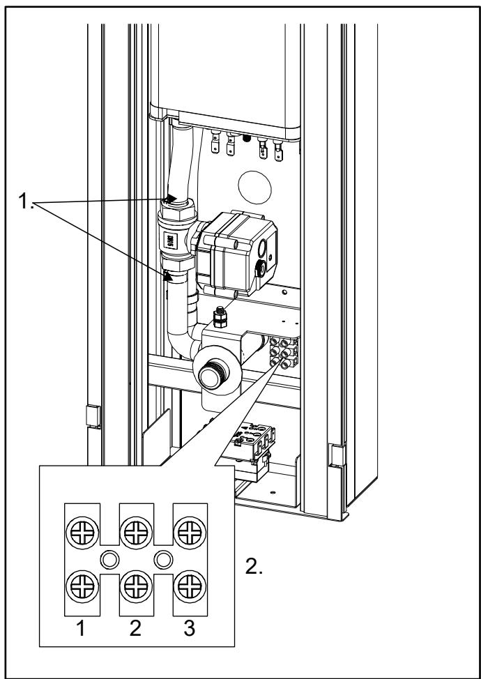
Fig. 19 Byte av motorkulventil
