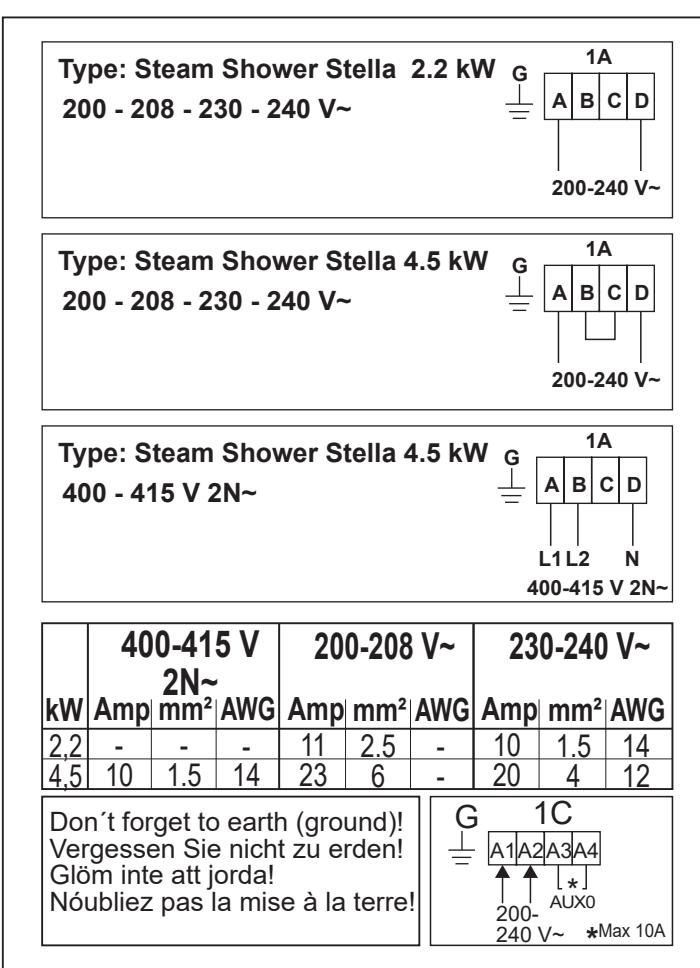
Rys. 7. Schemat połączeń.
