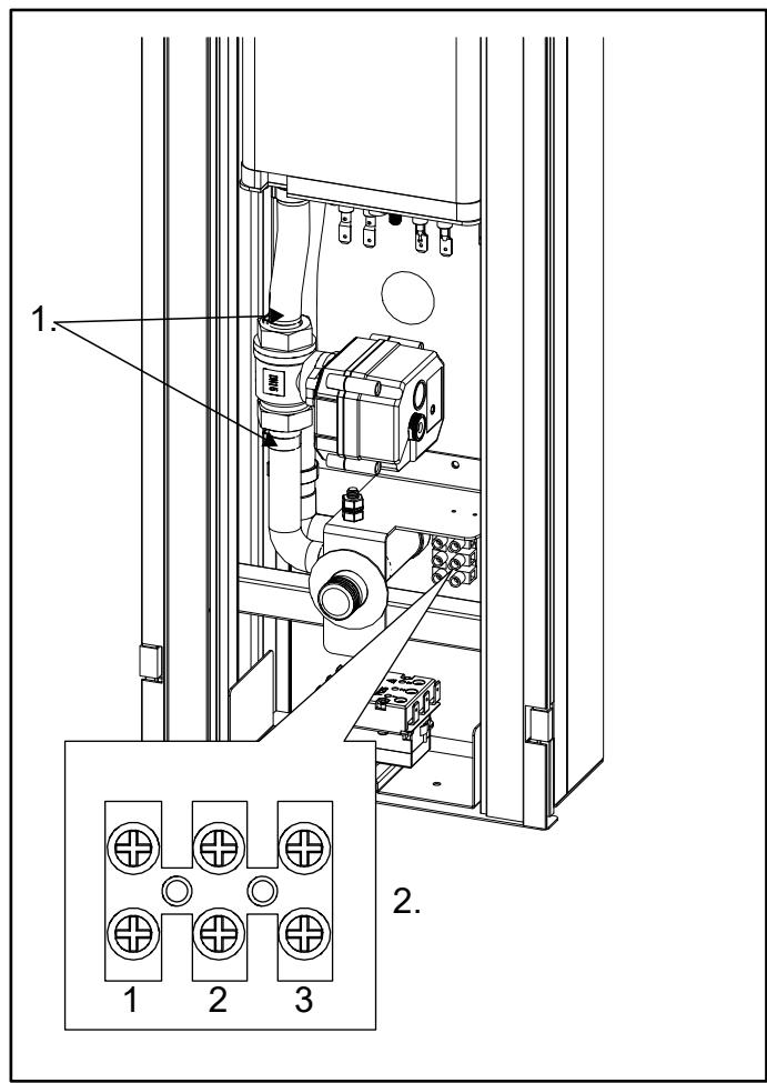
Figure 19 : Remplacement d'un robinet à boisseau sphérique motorisé
