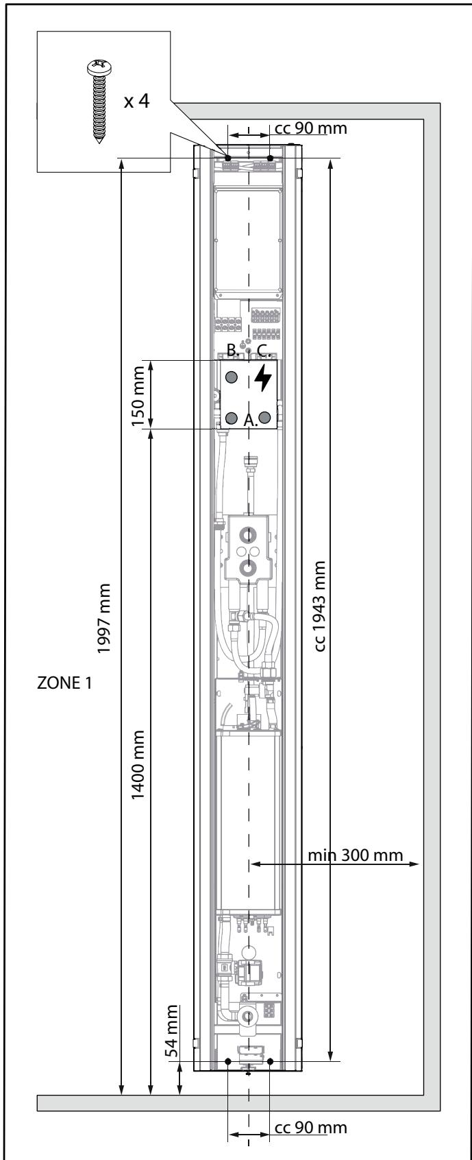
Fig. 2 Mått för montering, vatten- och elanslutning
