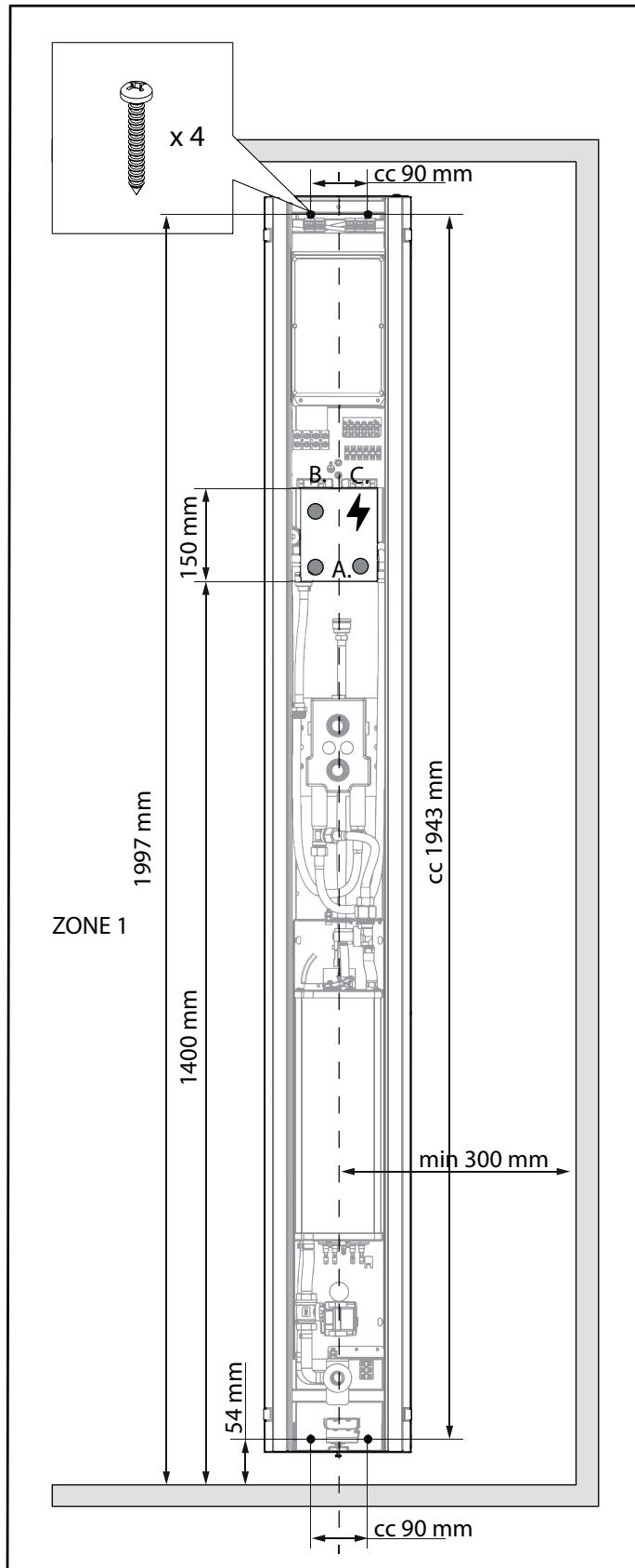
Afb. 2 Afmetingen voor installatie, water- en elektrische aansluiting
