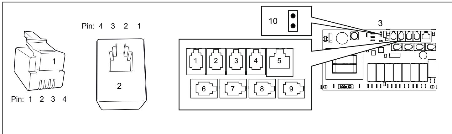
Afb. 10 Modulaire stekker/modulaire contactor en relaisbord "hoog"
