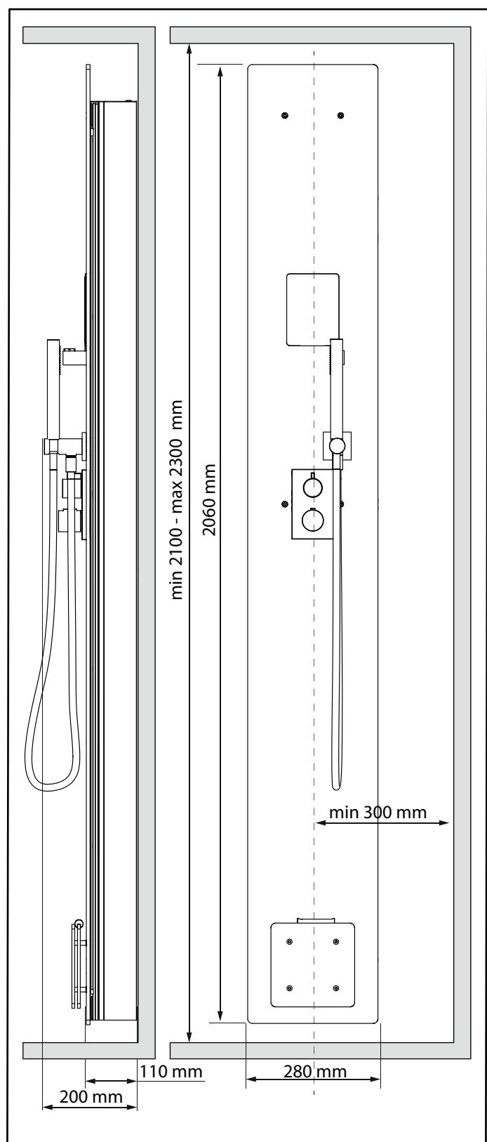
Rys. 1. Wymiary w milimetrach, kolumna parowa typu Stella.
