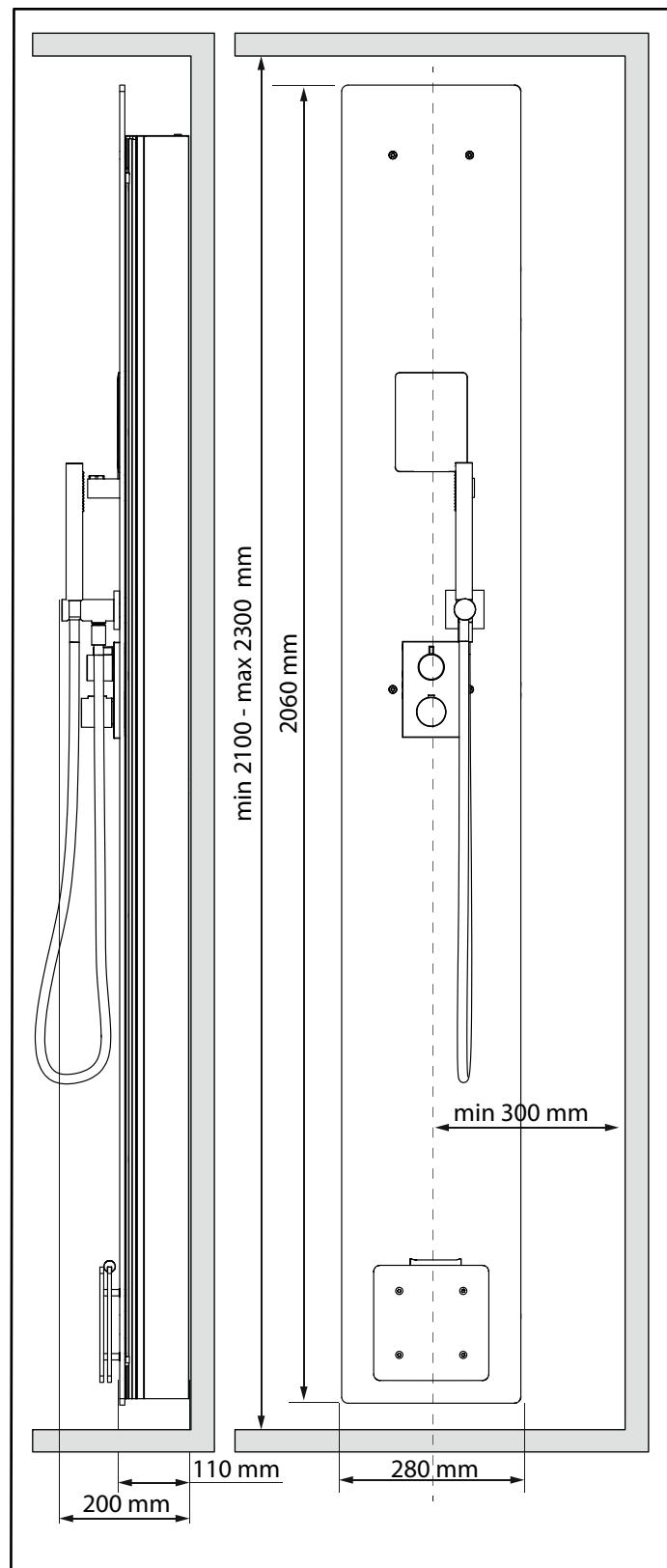
Abb. 1 Maße in Millimetern, Dampfsäule Typ Stella
