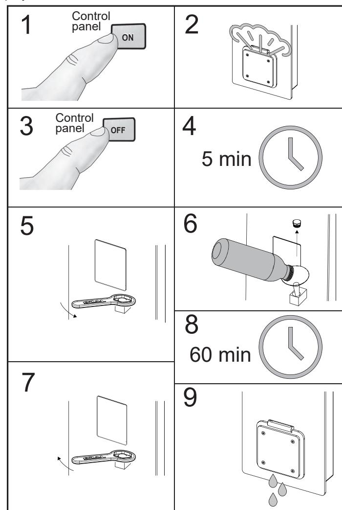
Rys. 12. Kroki procedury usuwania kamienia z wytwornicy pary.
