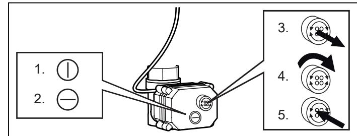
Kuva 18: 1. Pystyviiva osoittaa venttiilin olevan auki
