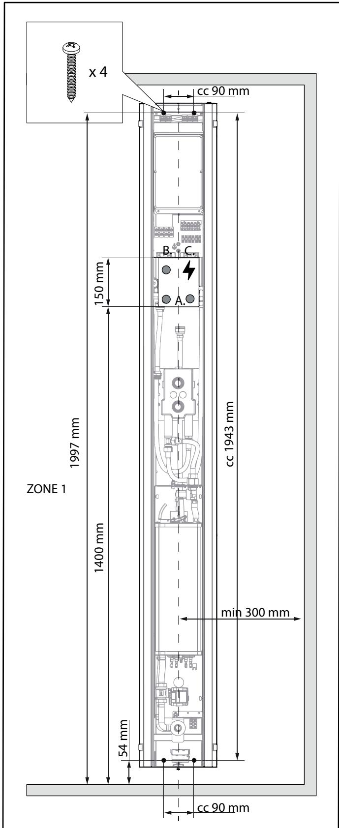
Abb. 2 Maße für Installation, Anschlüsse für Wasser Strom
