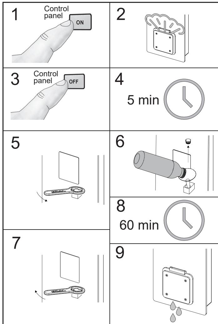
Fig. 12 Följ de olika stegen vid avkalkning av ånggeneratorn
