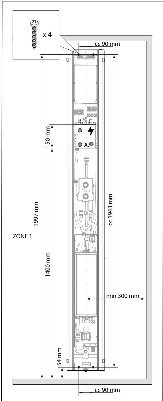
Rys. 2. Wymiary montażowe, przyłącza wodne i złącza elektryczne.
