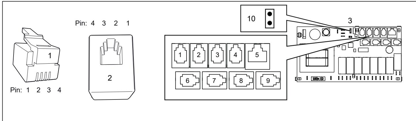
Рис. 10 Модульный штекер / модульный контактор и релейная плата
