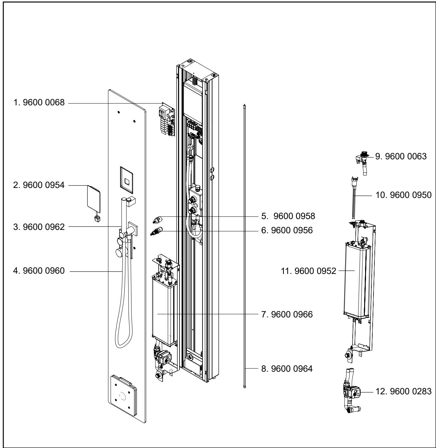
Abb. 11 Ersatzteile
