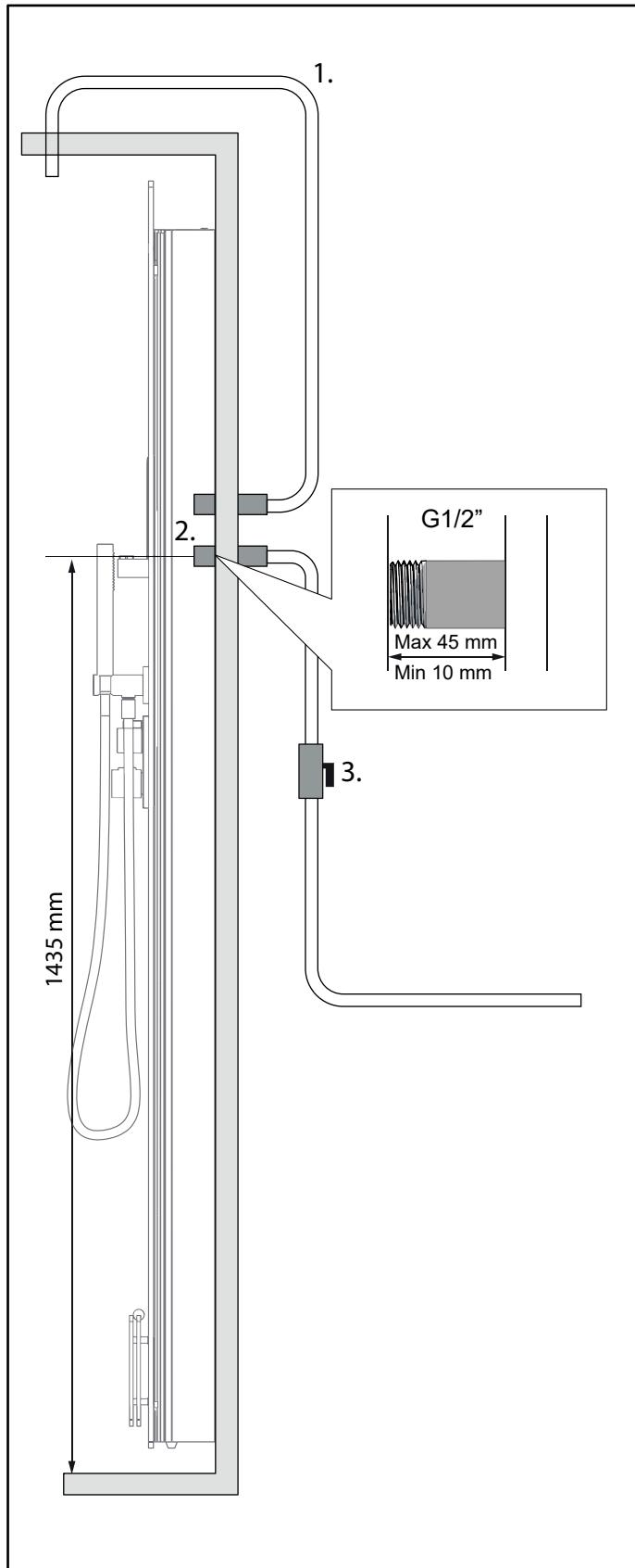
Abb. 3. Wasseranschluss
