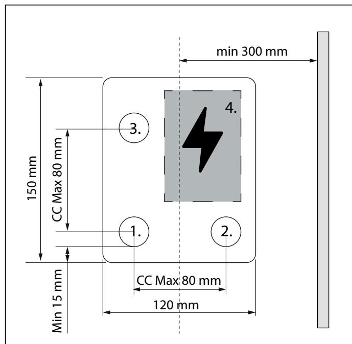
Rys. 4. Przyłącza rur.
