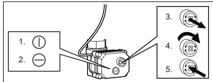
Afbeelding 18: 1. Verticale lijn geeft open klep aan
