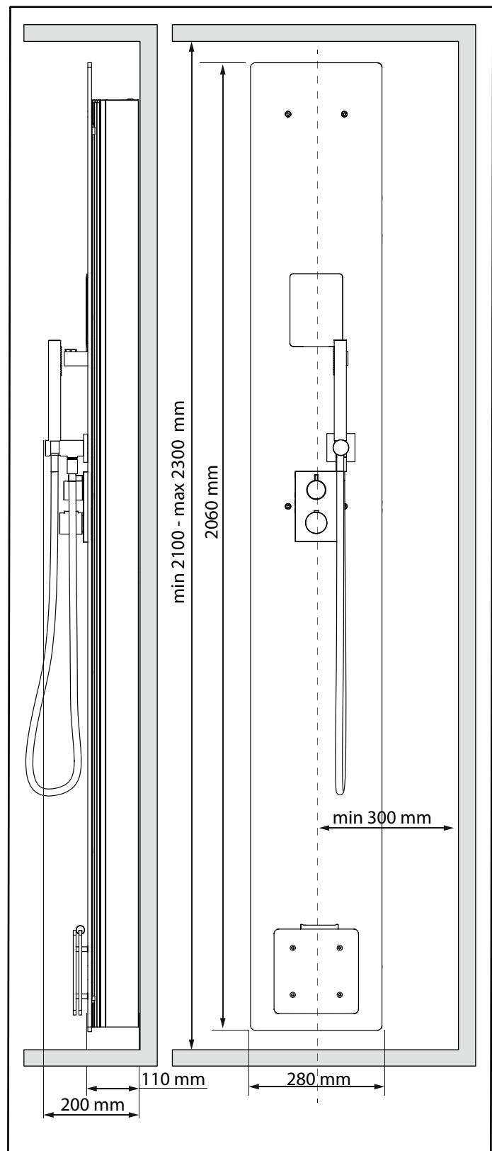
Fig. 1 Mått i millimeter, Ångpelare typ Stella
