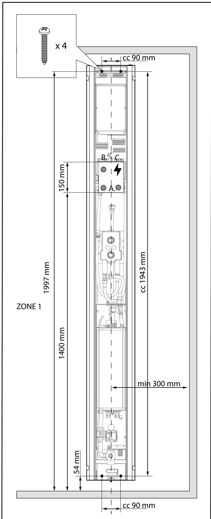
Kuva 2 Asennuksen mitat, vesi- ja sähköliittännät
