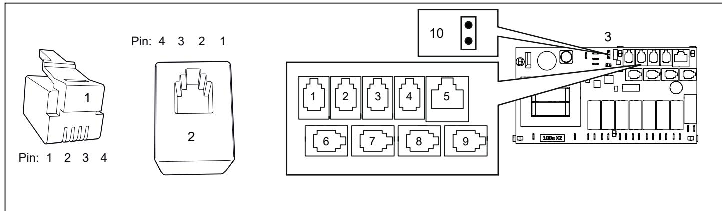
Rys. 10. Wtyczka/gniazdo złącza modułowego i płyta przekaźnikowa góra.
