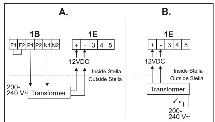
Rys. 8. Alternatywne okablowanie, oświetlenie.
