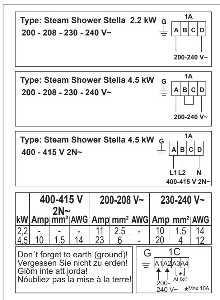
Рис. 7 Схема соединений
