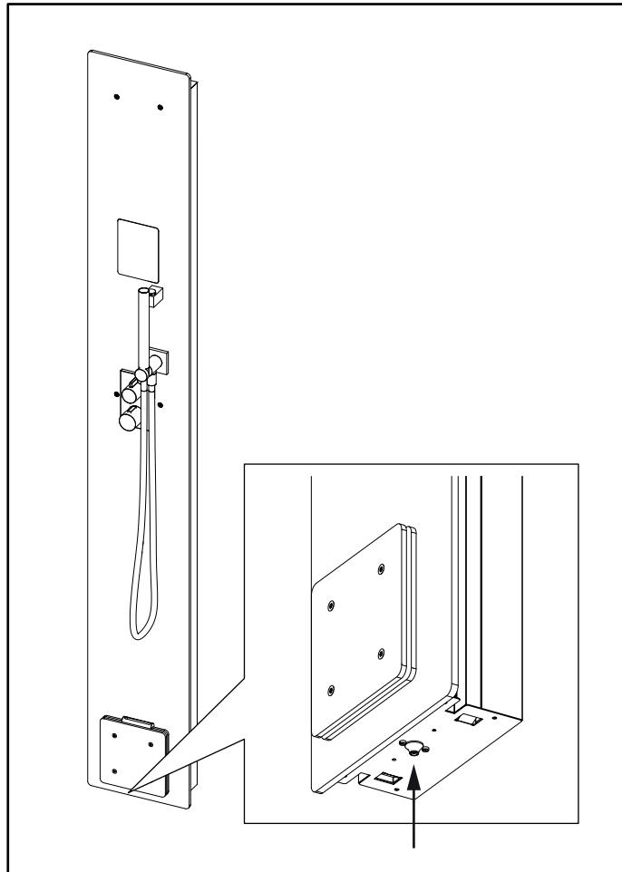
Abb. 13 Zurücksetzen des Überhitzungsschutzes
