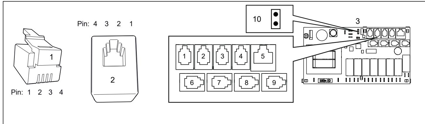
Kuva 10 Modulaarinen pistoke / modulaarinen kosketin ja relekortti "korkea"
