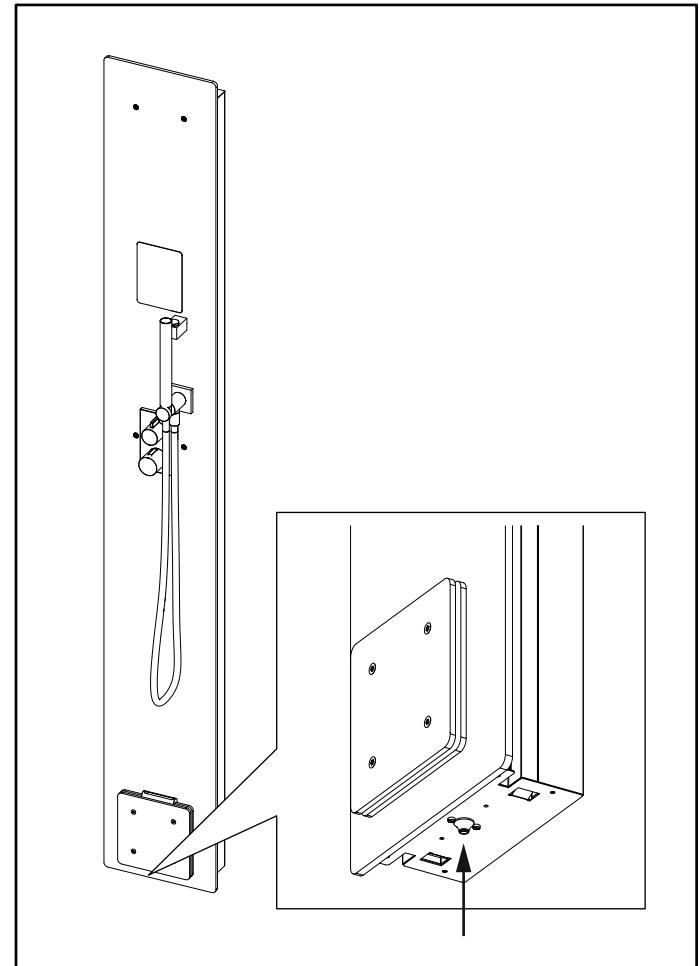
Figure 13 : Réinitialisation de la protection thermique
