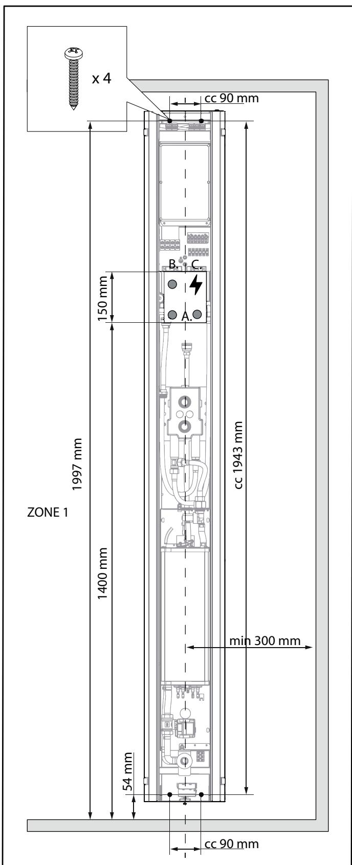
Рис. 2 Размеры для монтажа, подключения воды и электричества
