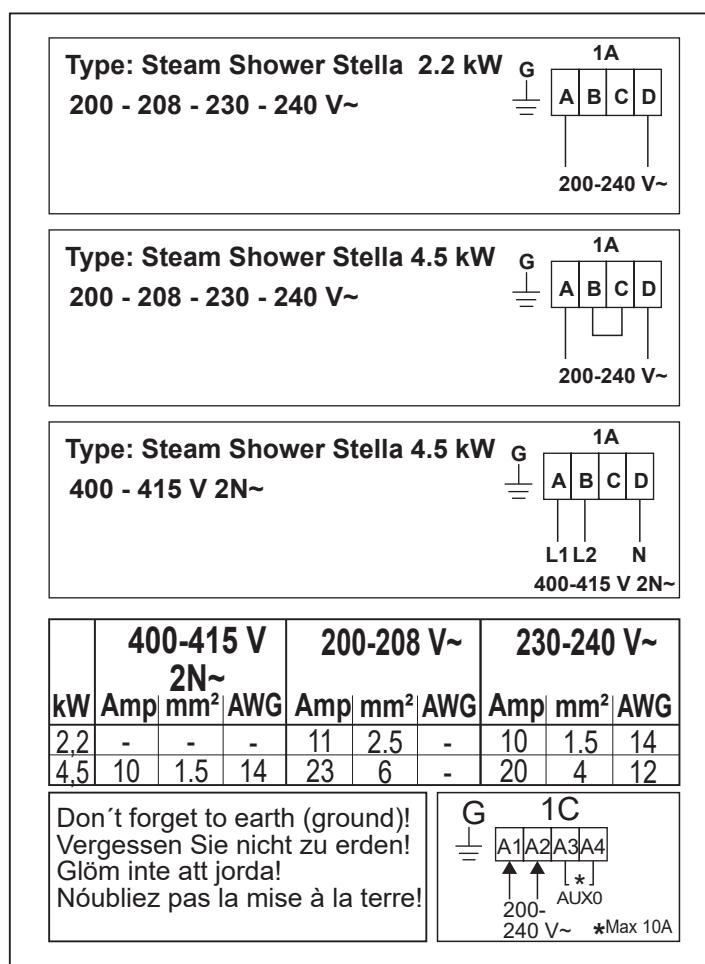
Fig. 7 Inkopplingsschema
