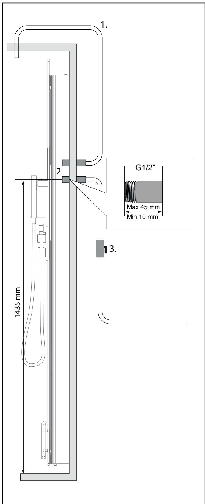
Rys. 3. Podłączanie wody.
