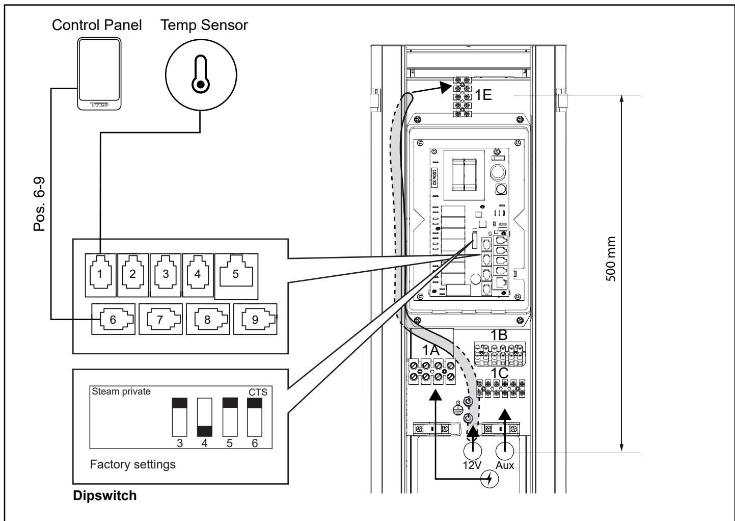
Rys. 5. Schemat połączeń wytwarzcy pary Stella.
