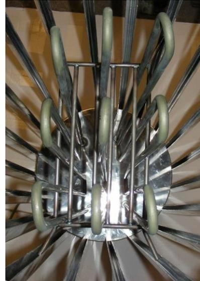
Spingere i perni a un'estremità del supporto nelle scanalature delle travi verticali.
