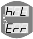
hiL Err (Errore limite massimo) spazio pietra surriscaldato (>400 °C), disconnessione elettronica.
