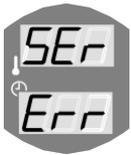
SEr Err (Errore seriale) errore di traffico seriale tra il riscaldatore e il controller.
